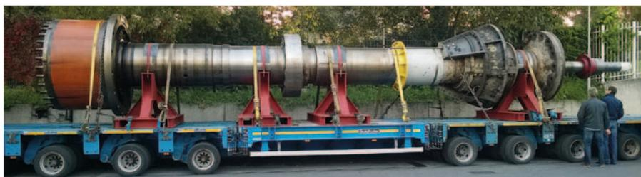
▲ Транспортировка вала агрегата (длина: 14,8 м, масса: 95 тонн)
