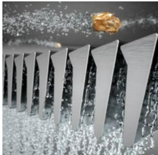
在需要良好筛选质量的位置,这种设计可以使用较低的波纹高度来满足;如果想要避免堵塞,保证运行性,就使用较高的波纹高度来满足。这种全新技术的良好应用效果已经经过安德里茨的实验室测试和近60家工厂应用的验证。
