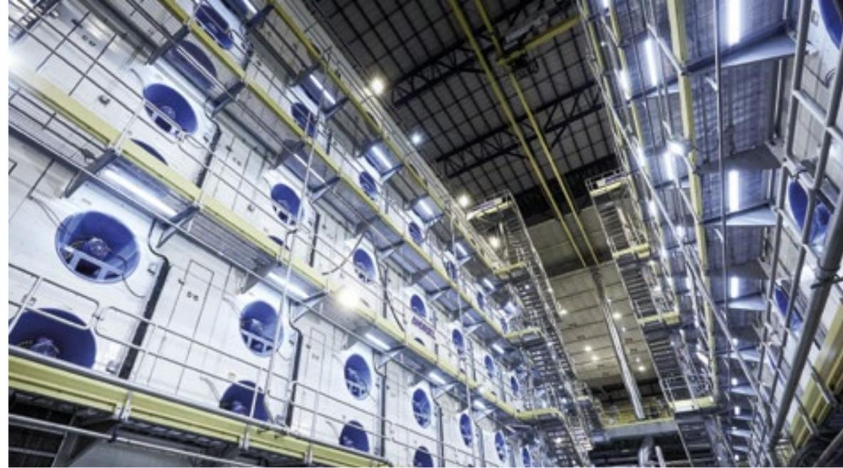
浆板机按照每米幅宽每天390吨的产能设计，这已在世界各地的安德里茨浆板机工厂得到了很好的证明
