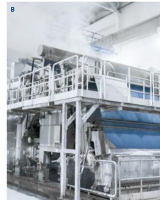
A PrimeDry Steel Yankee 钢制扬克缸完全由钢制成，直径20英尺，因此是世界上最大的扬克缸之一
