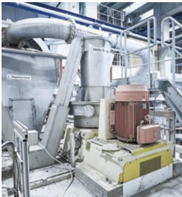
带排渣的碎解系统，包含130立方FibreSolveFSR碎浆机——目前为止安德里茨在欧洲安装的最大低浓碎浆机。
