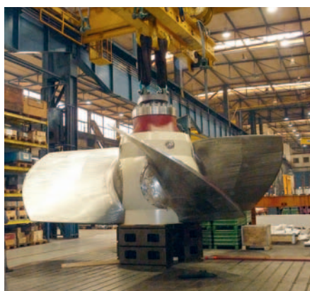
▣ Roue Kaplan en cours de fabrication
