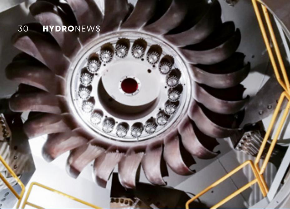
Die neue Pelton-turbine mit ausgesprochen gutem Teillastverhalten komplettiert die vorhandenen reversiblen Pumpturbinen.
