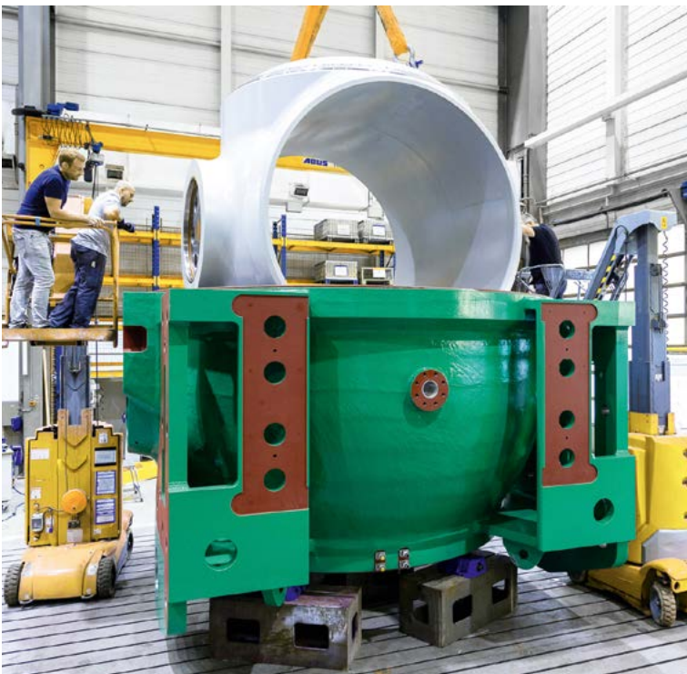
Montage des Drehkörpers in das Gehäuse des Absperrorgans
