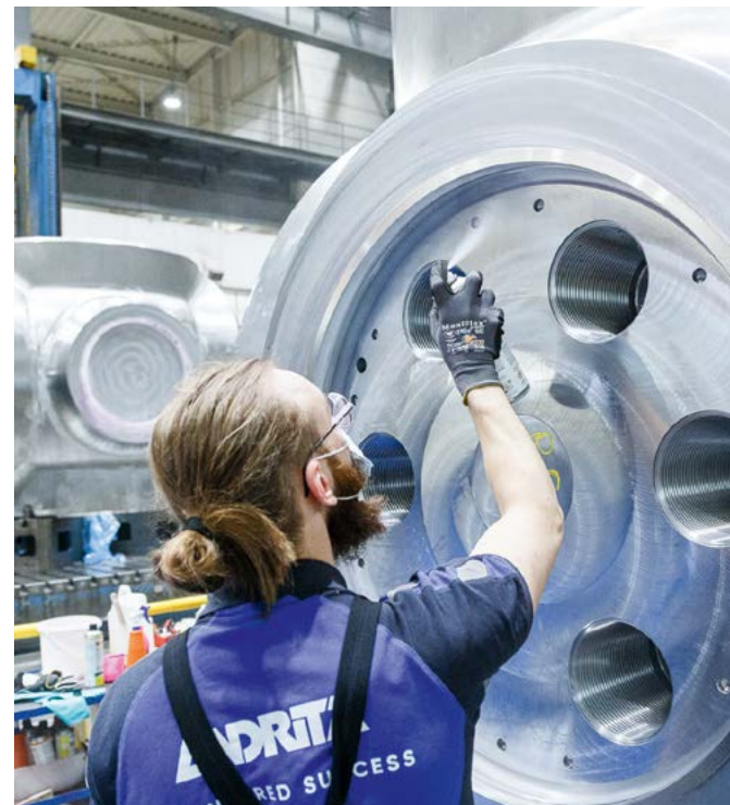
Rissprüfung an Dichtflächen des Drehkörpers
